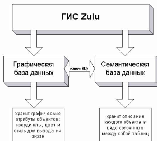
Рисунок 4.1. Структурная схема представления информации в системе Zulu
