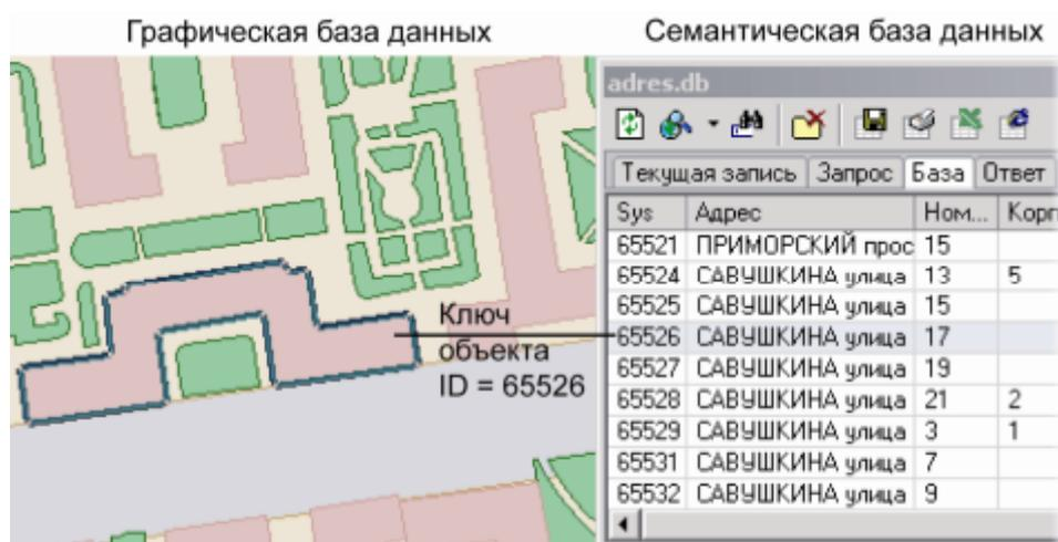
Рисунок 4.2. Пример взаимодействия семантической и графической баз данных
